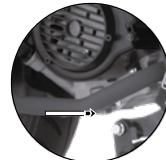
Imagen 16. Ubicación del tornillo de drenado de aceite.
