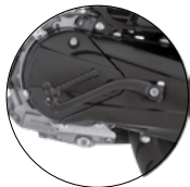
Imagen 10. Pedal de arranque.
