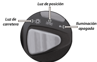
Imagen 2. Interruptor de luz delantera.
