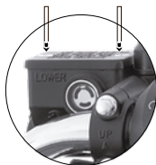
Imagen 26. Completar el nivel del líquido de frenos.
