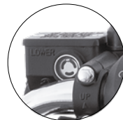
Imagen 25. Nivel del líquido del freno delantero.
