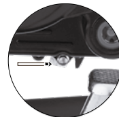
Imagen 16. Ubicación del tornillo de drenado.
