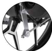
Imagen 24. Ajuste del pedal del freno trasero.
