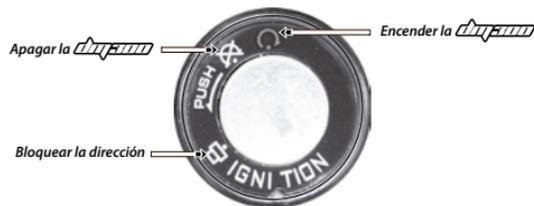
Imagen 8. Interruptor de encendido y bloqueo.
