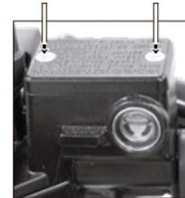
Imagen 27. Completar el nivel del líquido del freno delantero.
