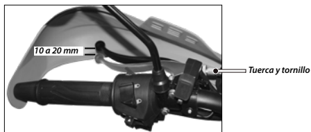
Imagen 22. Ajuste de la palanca del embrague.
