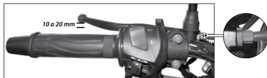
Imagen 21. Ajuste de la palanca del embrague.
